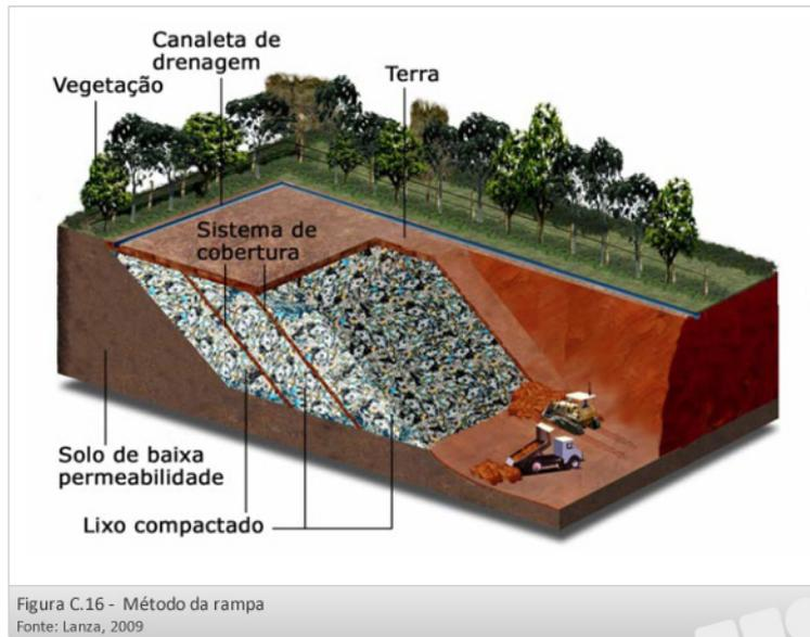
Figura C.16 - Método da rampa
