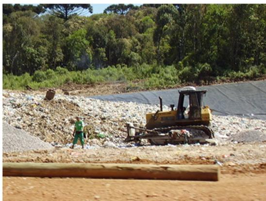
Figura E.11 - Trator de Esteiras D6H de 14000 Kg em operação no aterro
