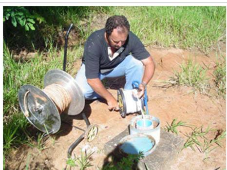
Figura F.2 - Coleta de amostra de águas subterrâneas
