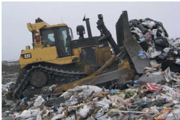
Figura E.10 - Operação de espalhamento de resíduos com trator de esteira modelo D9T
