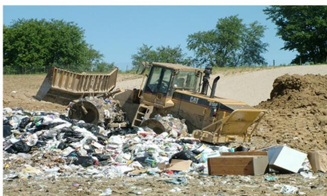
Figura E.12 - Trator compactador de aterro 836H peso de 55000kg
