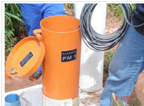
Figura F.3 - Poço piezométrico para coleta de amostra
