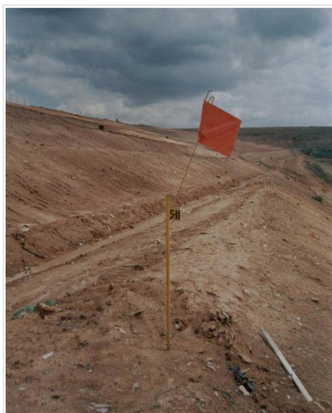
Figura C.11 - Medidor de recalque superficial instalado e identificado
