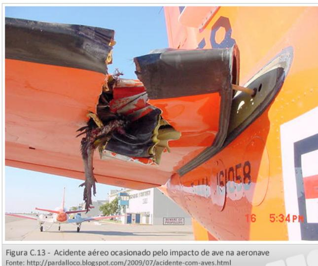
Figura C.13 - Acidente aéreo ocasionado pelo impacto de ave na aeronave
