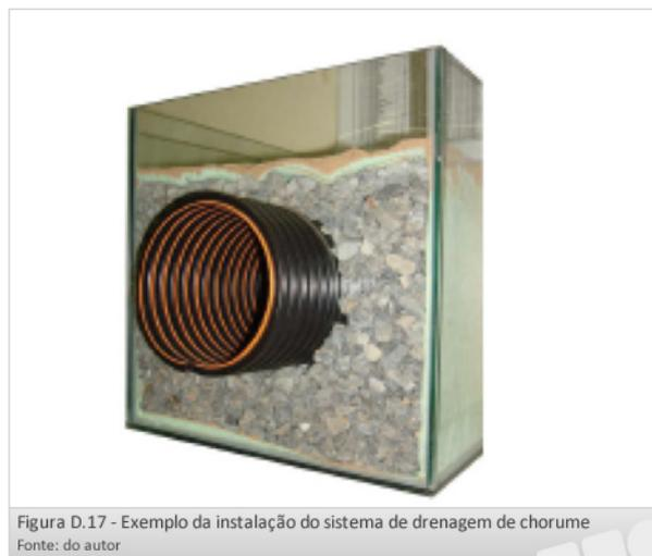
A rede de drenagem de chorume deve abranger toda a superfície de base do aterro, de forma a ser capaz de captar e escoar os líquidos que atravessam a massa do aterro para uma caixa de acumulação localizada em ponto de cota inferior ao aterro.
