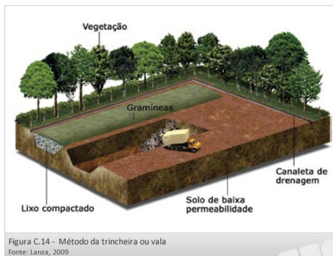
As trincheiras variam de 30m a 120m de comprimento por 4,5m a 7,5m de largura e 1,20m a 1,80m de profundidade. O comprimento é função da quantidade de resíduos a ser disposta em determinado período de tempo (geralmente três meses).
