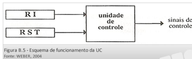
Cada sinal de controle gerado por ela comanda uma micro-operação a ser realizada. Ela recebe como entrada o valor do Registrador de Instrução e decodifica-o, juntamente com os sinais de saída da ULA (RST). Para cada código de instrução ela gera uma sequência de sinais diferentes, ativando os circuitos correspondentes para que cada uma das tarefas necessárias para a busca e execução da instrução seja completada.
