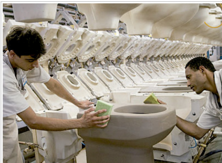
Figura D.13 - Moldagem da peça Fonte: site da revista Equipe de obra
