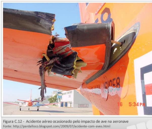
Figura C.12 - Acidente aéreo ocasionado pelo impacto de ave na aeronave
