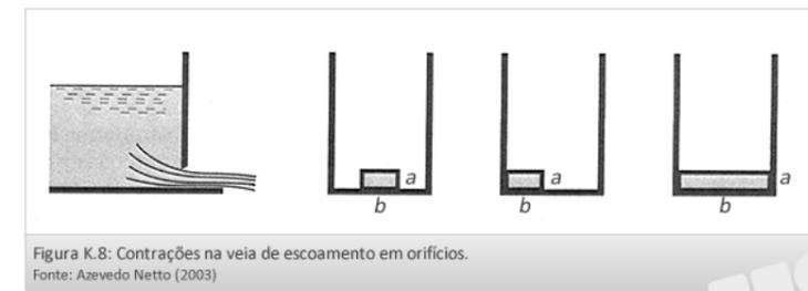
Figura K.8: Contrações na veia de escoamento em orifícios.
