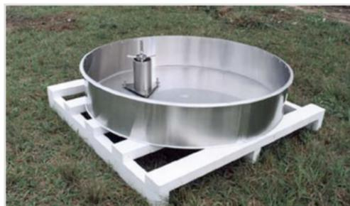
Figura E.6: Tanque classe A
