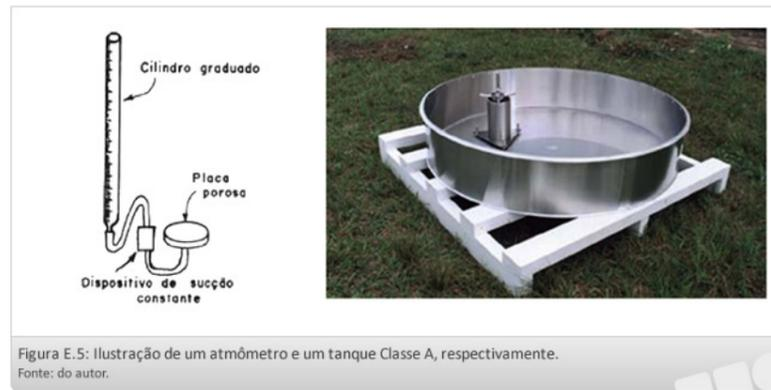
Figura E.5: Ilustração de um atmômetro e um tanque Classe A, respectivamente.
