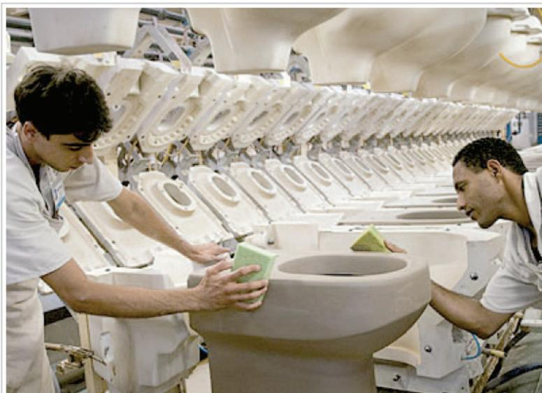
Figura D.13 - Moldagem da peça
