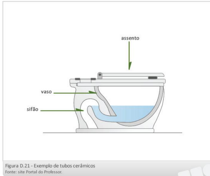
De acordo com a NBR 15097 a bacia sanitária deve ter formato que possibilite uma altura de água dentro do sifão, também chamada de fecho hídrico, de no mínimo 50 mm e o sifão deve ter dimensões de forma a deixar passar uma esfera rígida de diâmetro  $40\text{ mm} \pm 0,25\text{ mm}$ .
