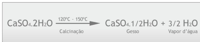
De acordo com Oliveira (2008) o gesso, ao ser misturado com água, torna-se plástico e enrijece rapidamente, retornando a sua composição original. Essa combinação faz-se com a produção de uma fina malha de cristais de sulfato hidratado, interpenetrada, responsável pela coesão do conjunto. Esse fenômeno conhecido como pega é acompanhado de elevação de temperatura, tratando-se de uma reação exotérmica.
